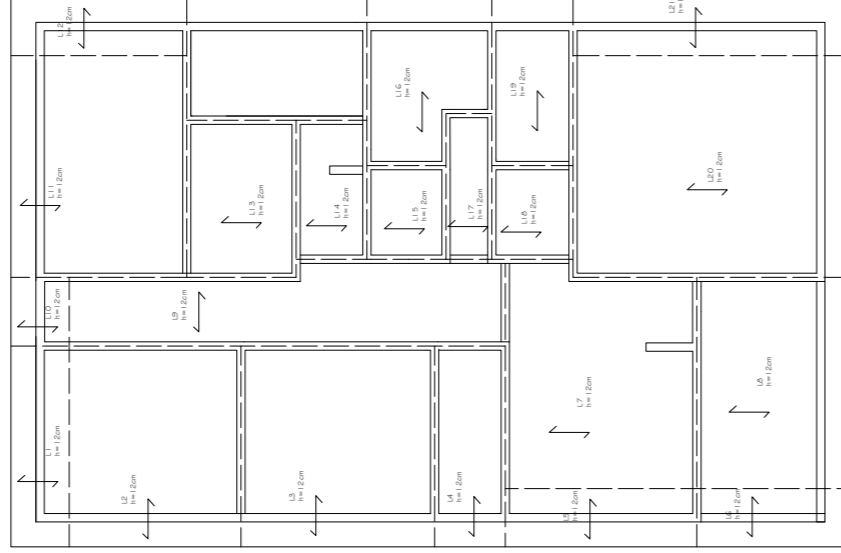
Planta de Localização das Lajes Escala 1/50
